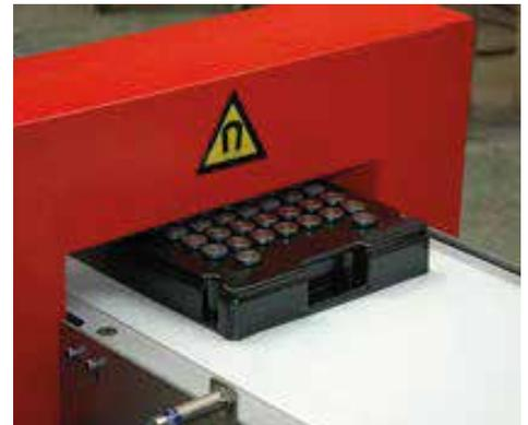
Los túneles desmagnetizantes de baja frecuencia son adecuados para objetos de paredes gruesas o sólidos de hasta 500 mm, tales como:
